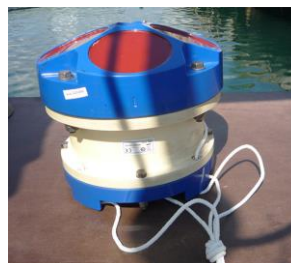
Работа с подводным автономным устройством радиационного и химического мониторинга и акустическим доплеровским профилографом течений
