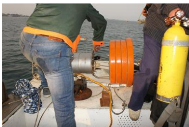
Работа с подводным автономным устройством радиационного и химического мониторинга и акустическим доплеровским профилографом течений
